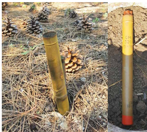
Рис. 137. Сигнальная мина СМ: 1 — взрыватель МУВ (МУВ-2, МУВ-3); 2 — корпус с электроин- воспламенителем КВ-11; 3 — гайка; 4 — резиновое кольцо; 5 — палец; 6 — пружинный чехол; 7 — воспламенительный состав; 8 — лючковый состав; 9 — корпус мины; 10 — сигнальная звезда; 11 — лючковый выключатель; 12 — картонная прокладка; 13 — окраска: перед корпусом белый, желтый или красный; 14 — этикетка; 15 — проволочная растяжка; 16 — дуговая выемка
